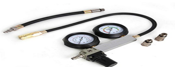
Рисунок. Общий вид пневмотестера.
